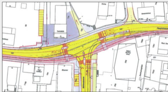
Die Skizze zeigt den Böhler-Knoten mit «T-Kreuzung» und Ampeln: Tankstelle, Kirchenmauer und Gemeindehaus in der oberen Hälfte des Bildes setzen räumliche Grenzen. Für eine voll ausgebaute T-Kreuzung stehen sind im Weg. (Bild: Kanton Aargau)
